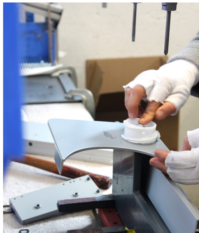
Viele Teile werden per Hand montiert – hier der Bedienknopf des Alleschneiders.
